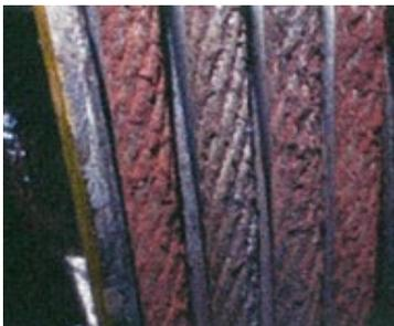
上記の要是正指摘の中には、左の写真のように主索の錆が著しいものが14台あります。主索の破断事故を発生させないよう早急に主索の交換をお願いします。主索交換完了まではエレベーターを停止(使用禁止)するなどの措置を所有者・管理者に申し入れることも必要です。また、プレーキパッドの摩耗による要是正指摘はエレベーターで4台、小荷物専用昇降機で7台あります。制動力不足によるスリップ、戸開走行事故の恐れがあります。早急な部品交換等の措置を実施願います。
